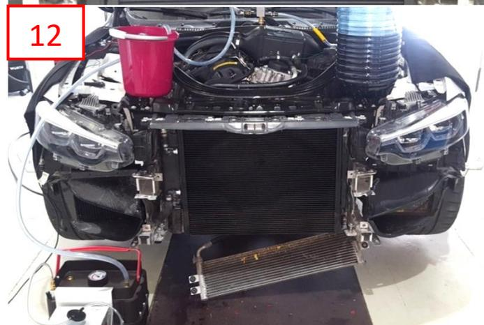
Aufgrund von Fertigungstoleranzen **kann** es vorkommen, dass zwischen WT Carbon Luftführung und WT Wasserkühler ein kleiner Luftspalt bleibt. In diesem Fall versehen Sie die WT Carbon Luftführung noch vor dessen Montage mit den mitgelieferten Kantenschutzbändern, damit diese luftdicht zum WT Wasserkühler abschließen kann. Des Weiteren kann es nötig sein, die Luftauslässe in der Radhausschale zu beschleifen, um den seitlichen WT Wasserkühler problemlos montieren zu können.
